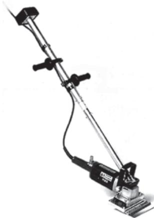
zum Entfernen von alten Bodenbelägen z. B. PVC oder Teppichboden, Beläge in Streifen schneiden und mit dem Powerstripper vom Untergrund abschälen, Belag vorher nicht von Hand entfernen. Untergrundabhängig
